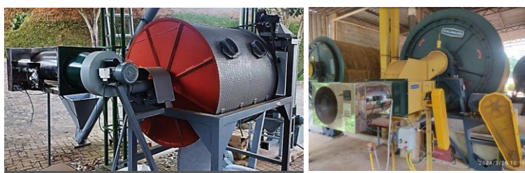
Figura 2. Vista parcial de secadores rotativos para agricultura familiar e grandes produtores, com geradores de calor através do sistema a Gás GLP e sistema de automação.
